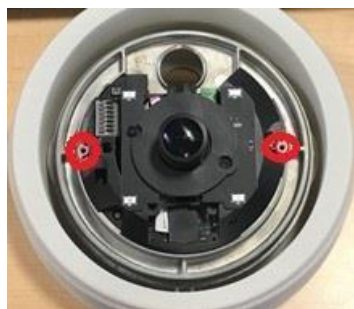
Figure 5. Emplacement des vis sur le corps de la caméra
