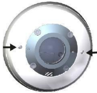
Figure 3. Emplacement des vis sur le cache avant de la caméra.
