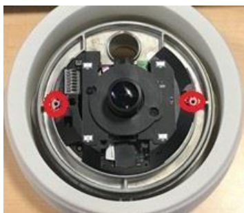
Figura 5. Punti di avvitamento sul corpo della telecamera
